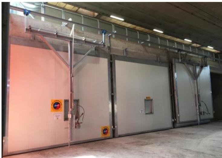
Figura 27 - Esempio di biocelle aerobiche
