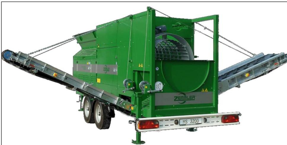
Figura 30 - Esempio di vaglio per le operazioni di raffinazione finale del compost
