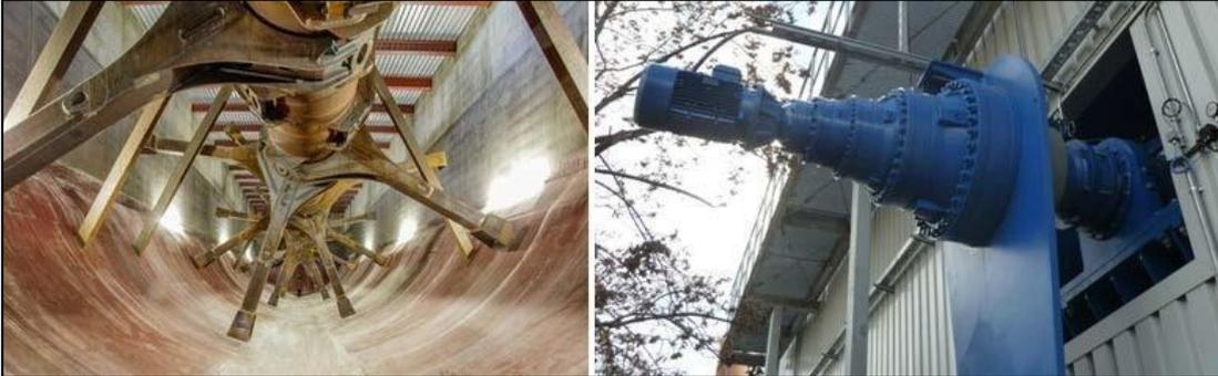
Figura 25 - Particolare dell'agitatore a pale e del motoriduttore epicicloidale
