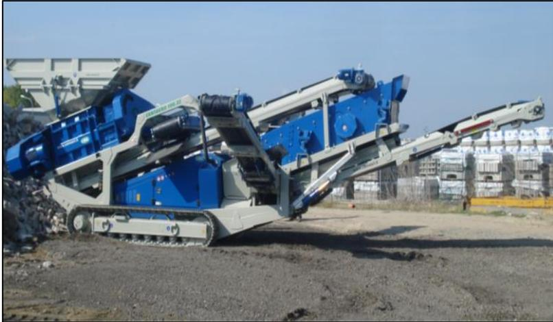
Figura 14 - Trituratore veloce per materiale ligneo-cellulosico
