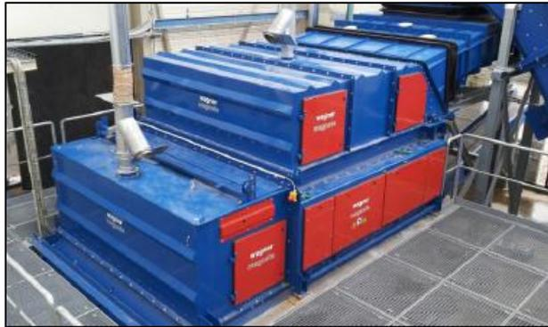
Figura 18 - Esempio di separatore a correnti indotte
