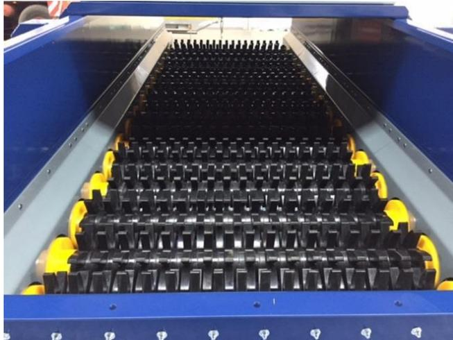
Figura 28 - Esempio di vaglio a dischi per le operazioni di vagliatura intermedia
